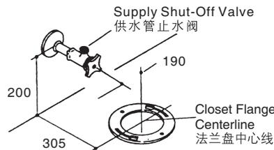
安装厕所供水管止水阀，使之离地线200mm，也离法兰盘中心线左面190mm。
