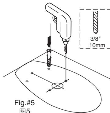
用10mm的钻头在地面上钻孔，然后插入螺栓套管。
