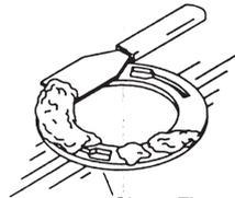
用涂油灰刀拆除地上的旧密封垫圈及座便器法兰盘，拆除及扔掉旧的T型螺栓。
